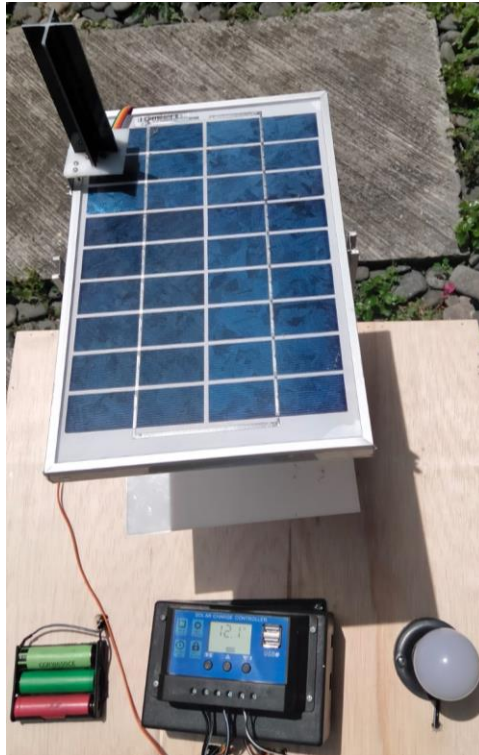
Gambar 4.12. Gambar Solar Panel Menghadap Lurus ke Atas
