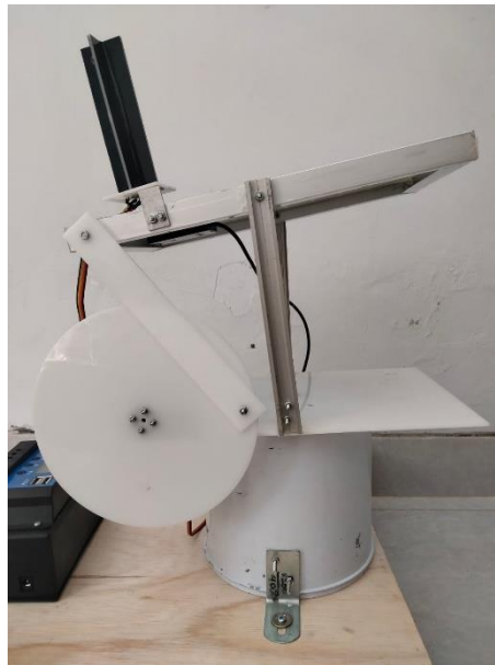
Gambar 4.9. Gambar Kerangka Solar Tracker
