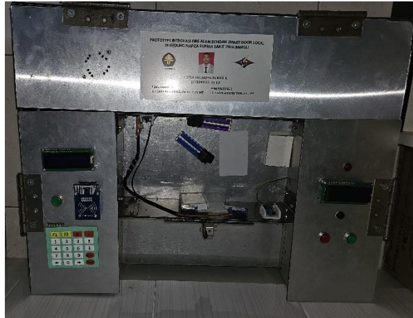
Lampiran 1 Gambar alat Prototype Integrasi Fire alarm dengan Smart Door Lock saat Sidang Skripsi
