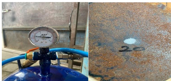
Gambar 4.2 Hasil Pengujian Penyemprotan Pertama pada tekanan 2 bar
