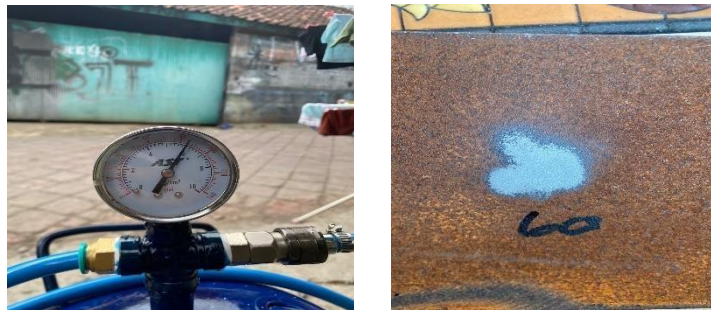
Gambar 4.4 Hasil Pengujian Penyemprotan Ketiga pada tekanan 6 bar
