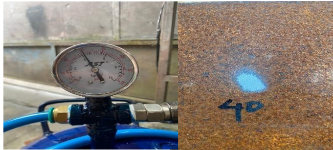
Gambar 4.3 Hasil Pengujian Penyemprotan Kedua pada tekanan 4 bar
