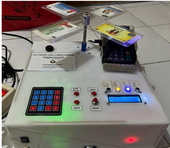
Gambar 4. 8 Pengujian Transaksi Mode Otomatis Menggunakan Alat Tapping Kartu E-money Otomatis
