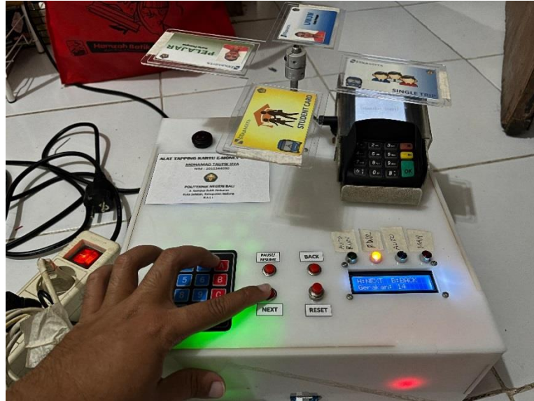
Gambar 4. 10 Pengujian Transaksi dengan Mode Manual Menggunakan Alat Tapping Kartu E-money Otomatis
