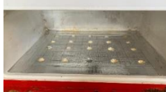
Gambar 13. Lubang aliran udara panas
