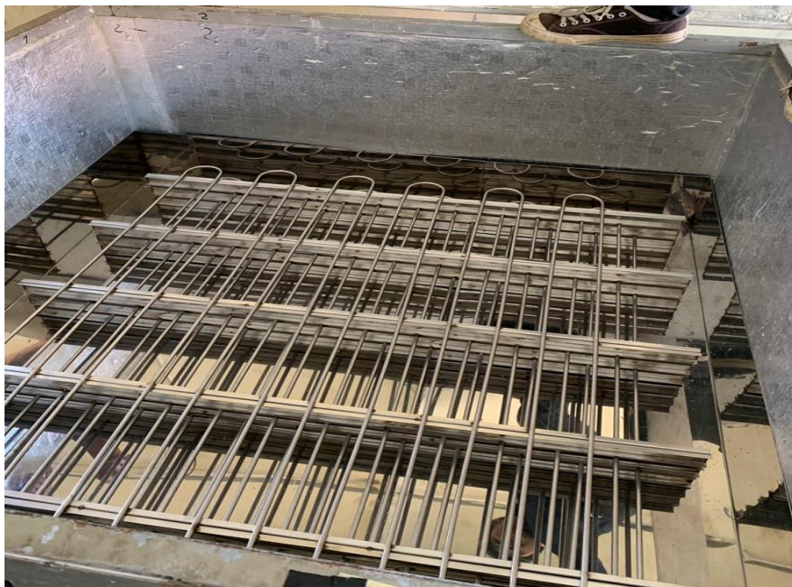
Gambar 4.17 Perakitan komponen mesin es di Lab. Tata udara PNB
