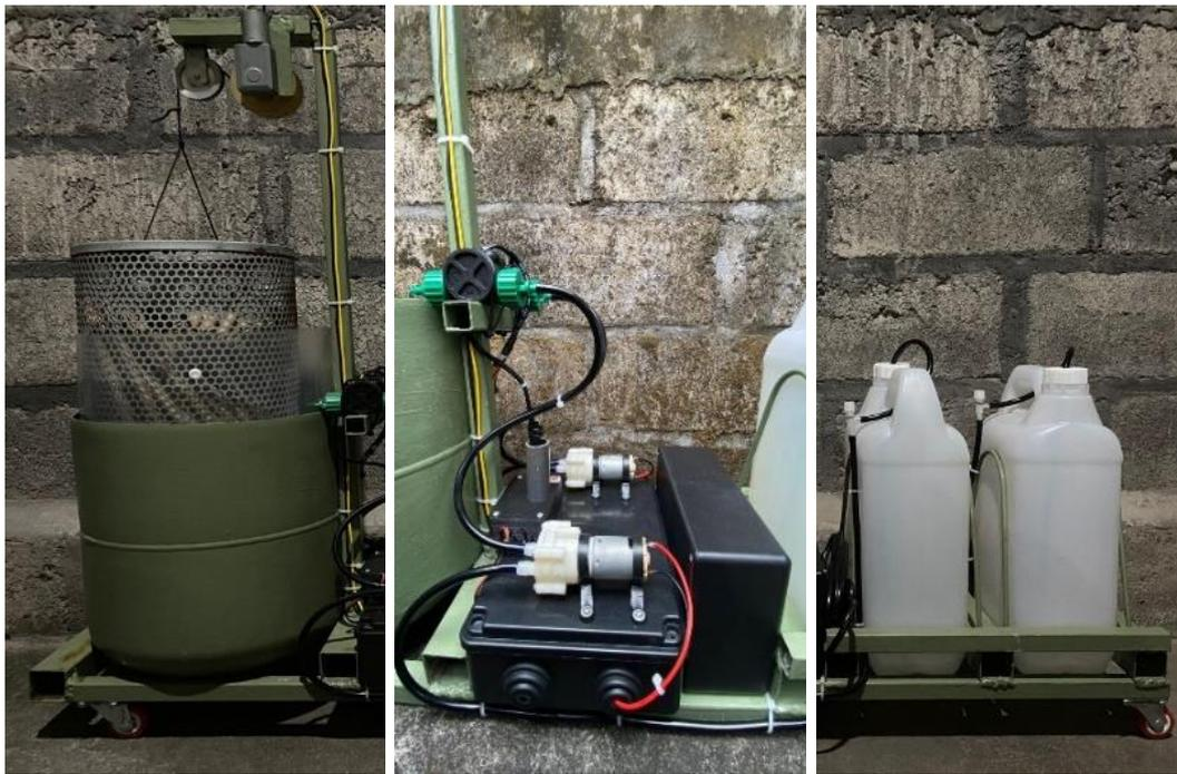
Gambar 2 (a) Bagian Tangki Perendaman (b) Bagian Tempat Komponen (c) Bagian Wadah Cairan
