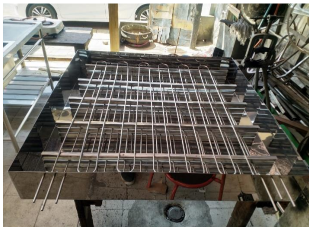
Gambar 2. Modifikasi Evaporator yang akan terendam PCM
