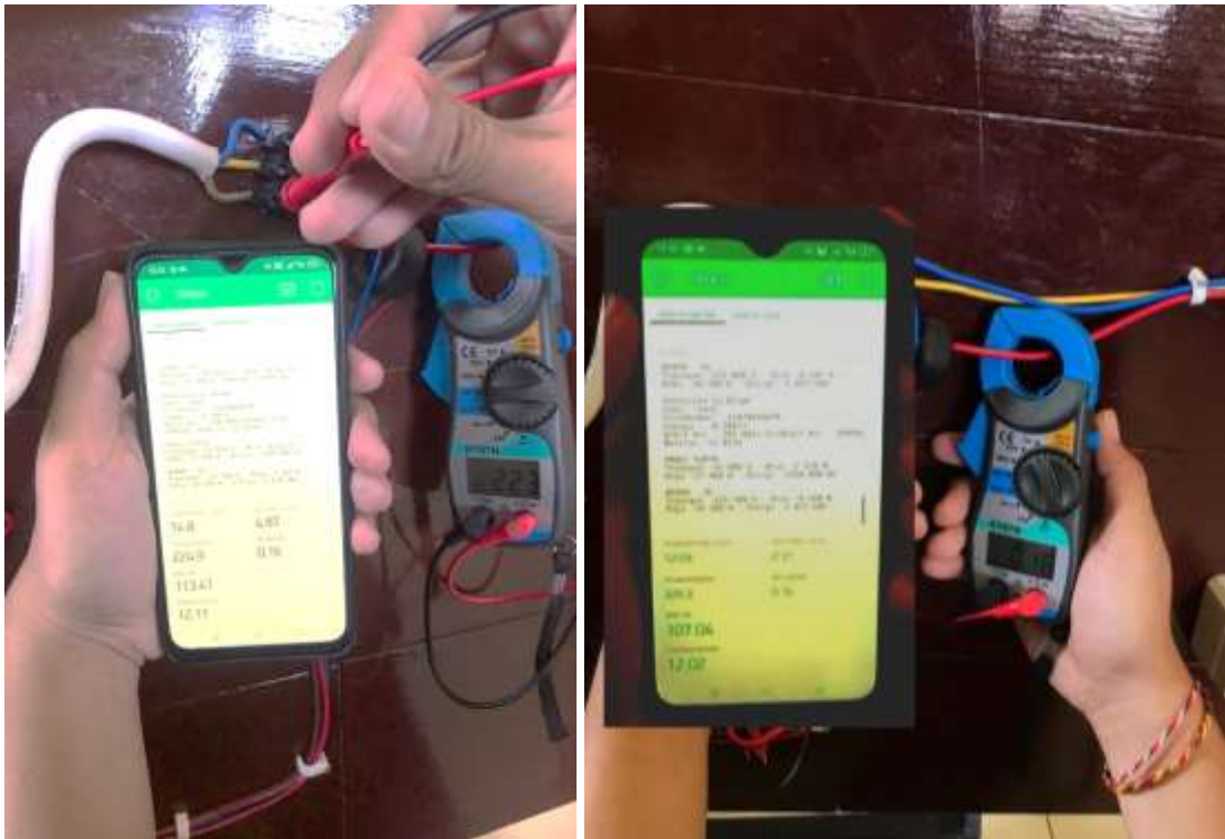
Lampiran 3. Pengujian Module PZEM-004T pembacaan tegangan dan arus
