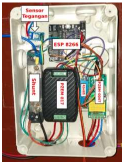
Gambar 4. 2 Kotak Mikrokontroller & Sensor
