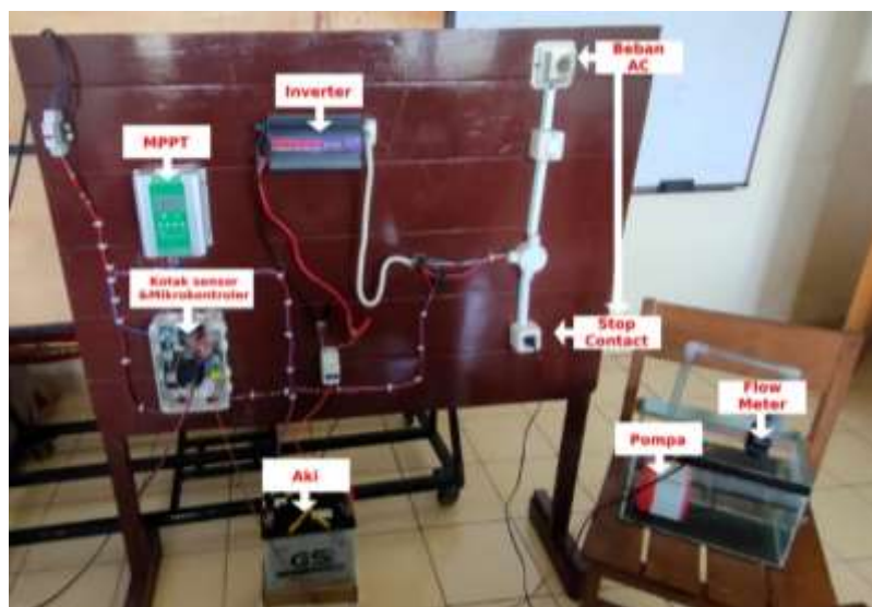
Gambar 4. 1 Simulasi pompa irigasi dengan (PLTS)
