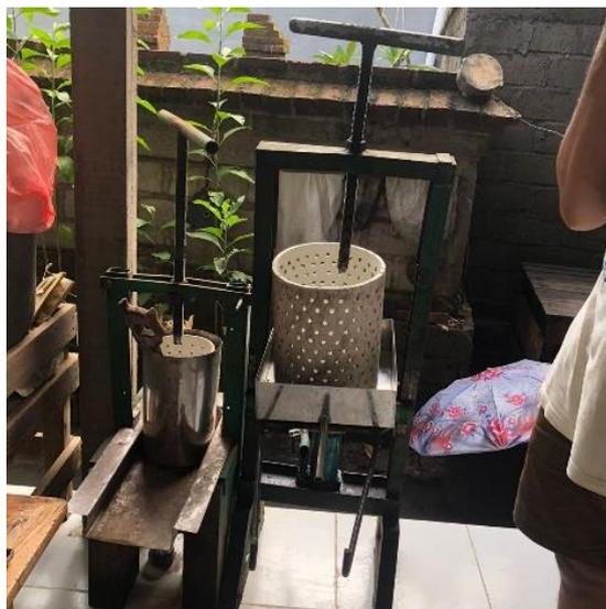
**Gambar 2. 4** Alat pemeras santan kelapa sistem ulir dan dongkrak hidrolik
