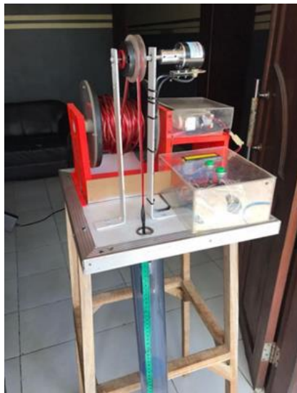
Gambar 5. Simulasi pengukuran muka air skala lab
