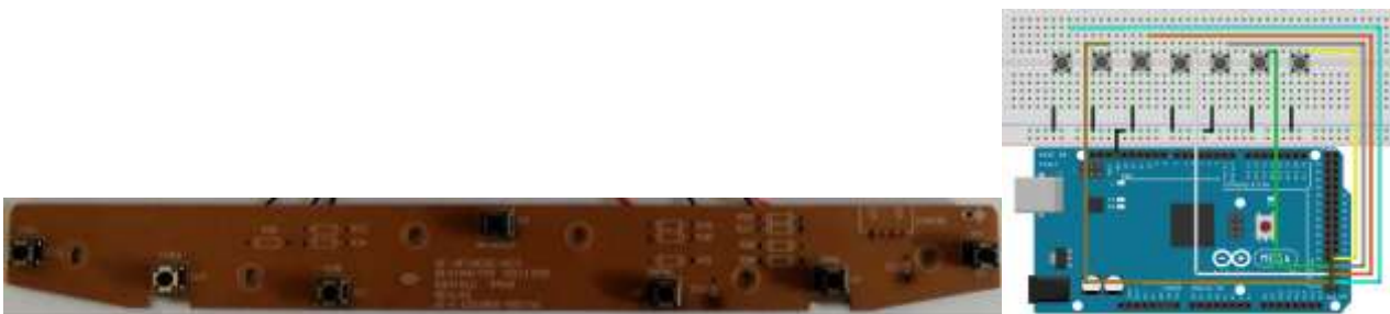
Gambar 8. PCB Push Button Dan Diagram Pengkabelan Push Button Dengan Arduino Mega 2560
