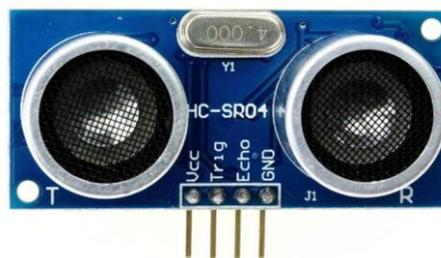
*Gambar 2. 6 Sensor Ultrasonik.*
