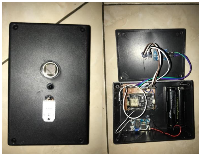
Gambar / Figure 1. Hasil rancangan sistem pendeteksi kebakaran
