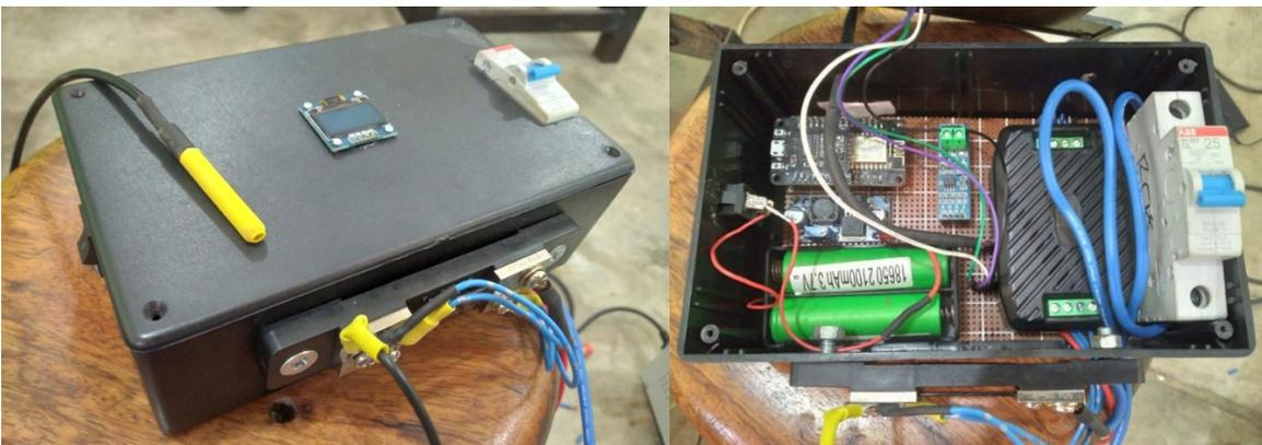
Gambar 4. Realisasi alat data logger
