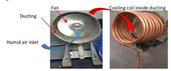
Fig. 6. Natural humidifier test rig.
