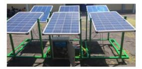
Fig. 2. Photovoltaic array test rig.
