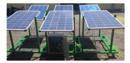
Fig. 2. Photovoltaic array test rig
