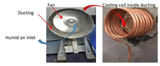
Fig. 6. Natural humidifier test rig
