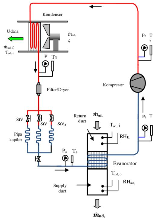
Gambar 1. Diagram pemipaian dan penempatan alat ukur
