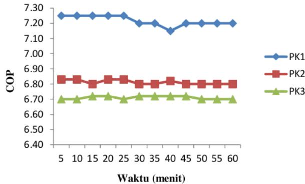
Gambar 3 Grafik COP untuk masing-masing pipa kapiler
