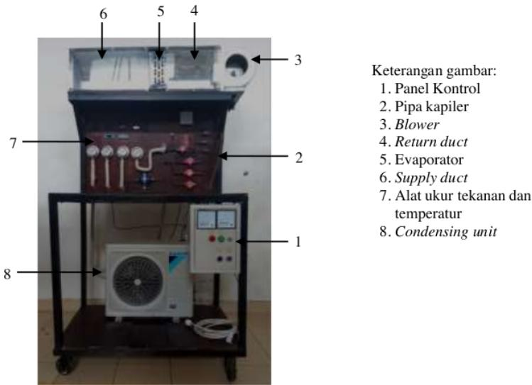
Gambar 2 *Test rig* AC jenis ekspansi langsung
