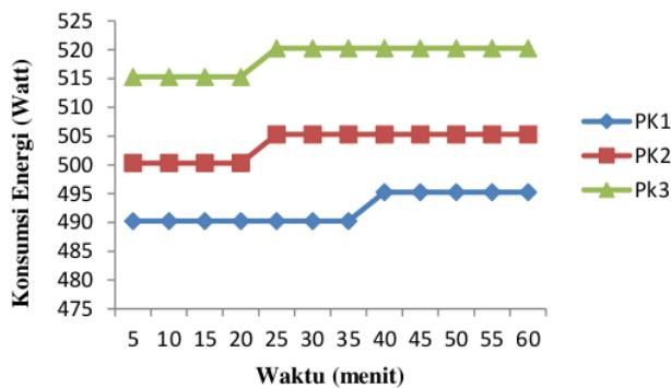
Gambar 4 Grafik konsumsi energi untuk masing-masing pipa kapiler
