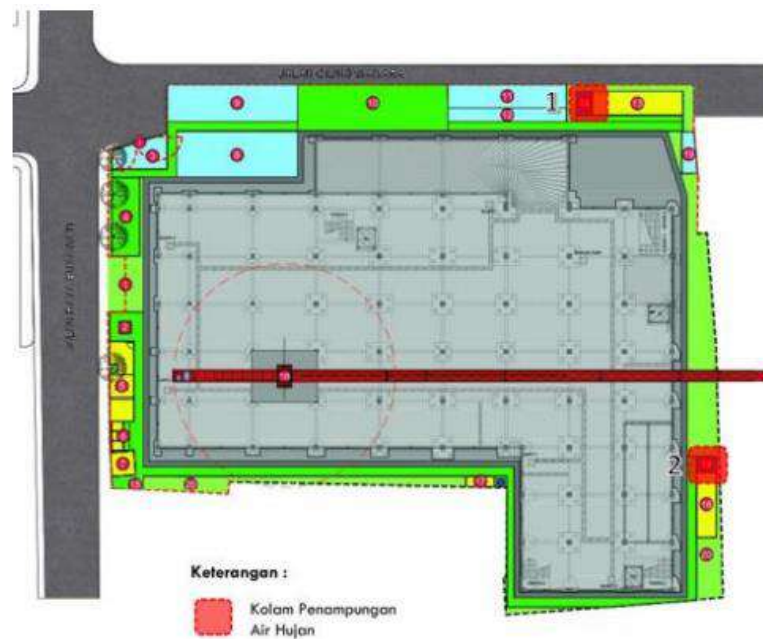
Gambar 4.51. Layout Penempatan Kolam Penampungan Air Hujan
