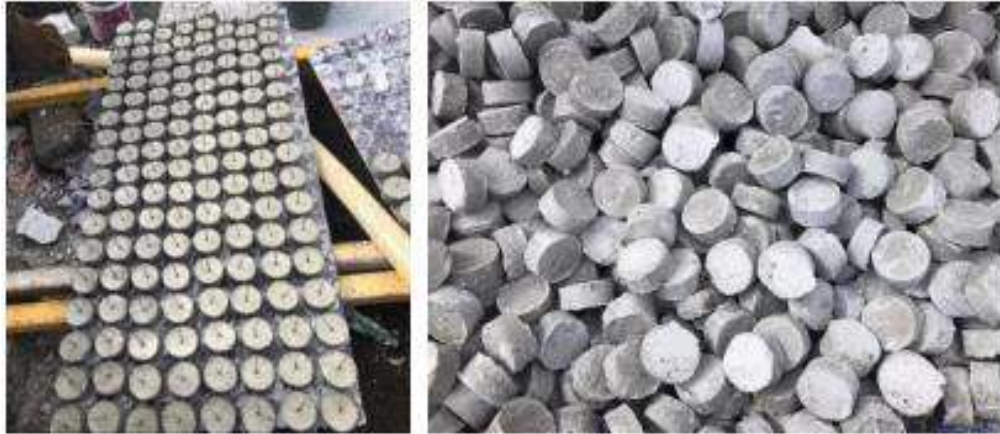
Gambar 4.23. Dokumentasi Pemanfaatan Sisa Cor Beton
