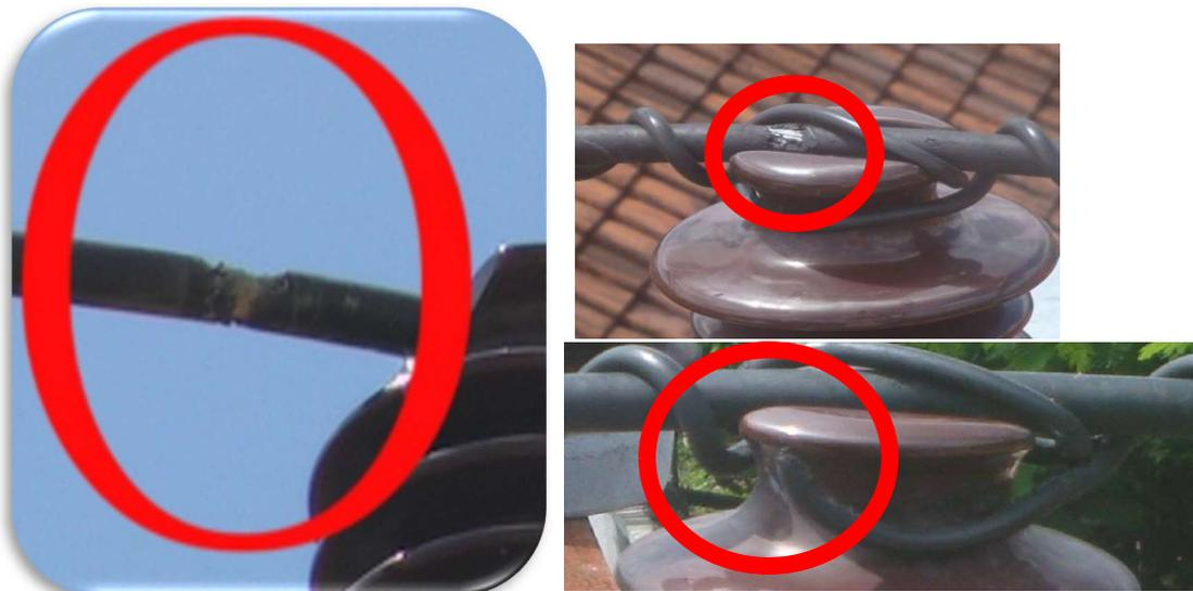
Gambar 9. Kerusakan akibat penggunaan Aluminium bending wire dan Preformed tie
