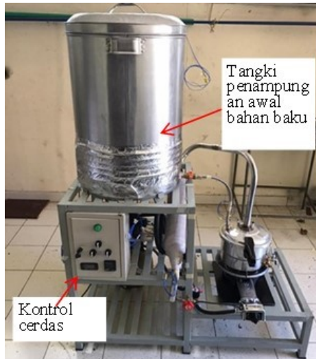
Gambar 1.4. Prototipe mesin distilasi arak menerapkan distilator refrigerasi dengan kondensor pendinginan natural
