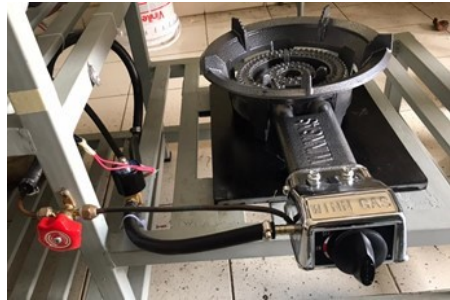
Burner dari boiler - penghasil uap
