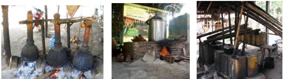
Gambar 1.2. Peralatan distilasi sederhana yang digunakan oleh petani Arak Bali
