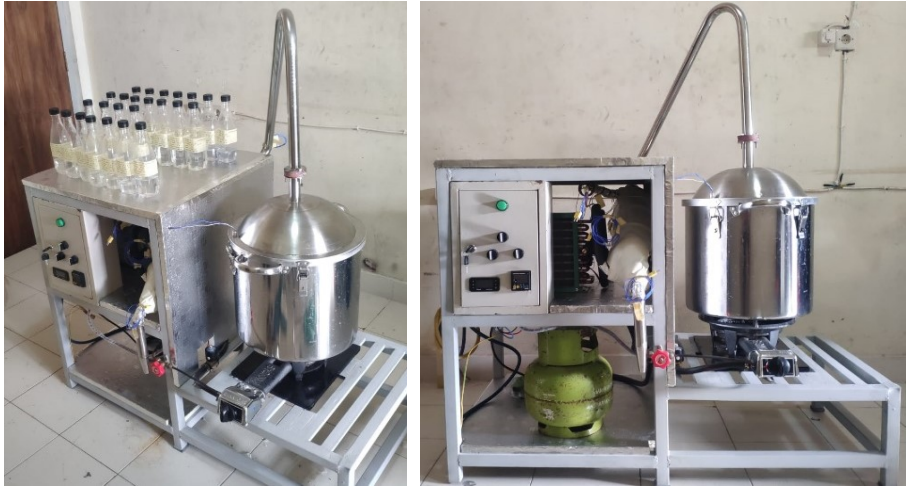
Gambar 2.5. Mesin distilasi secara individual tanpa pembangkit listrik tenaga surya
