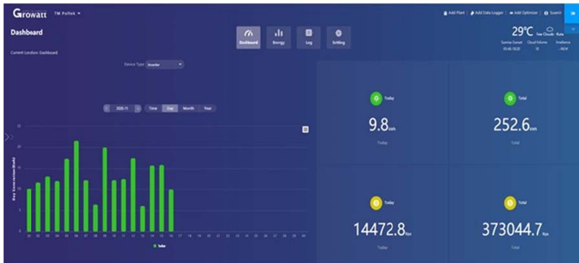
Gambar 2.2 Sistem monitoring untuk produksi energi sistem PLTS melalui komputer dengan jaringan internet
