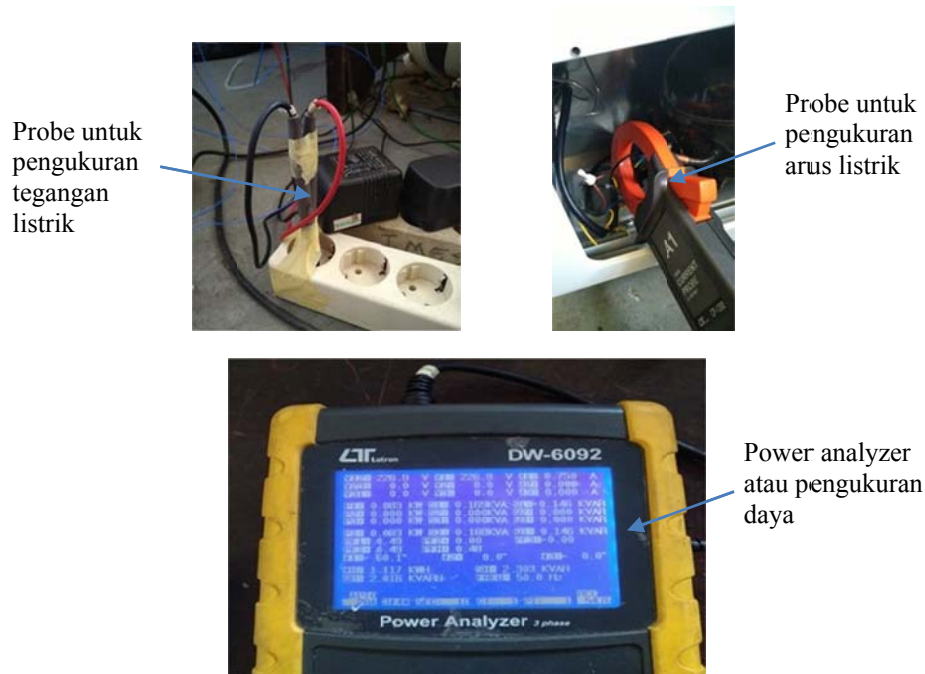
Gambar 5 Pengukuran daya kompresor
