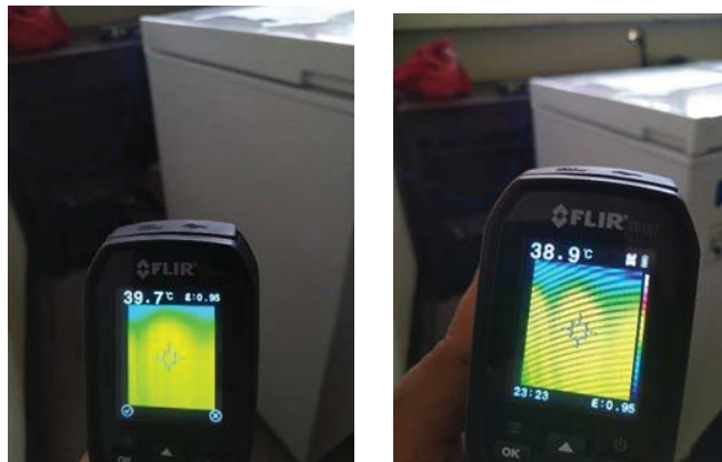
Gambar 2.7 Pengukuran tempertaer kondensasi thermal image camera
