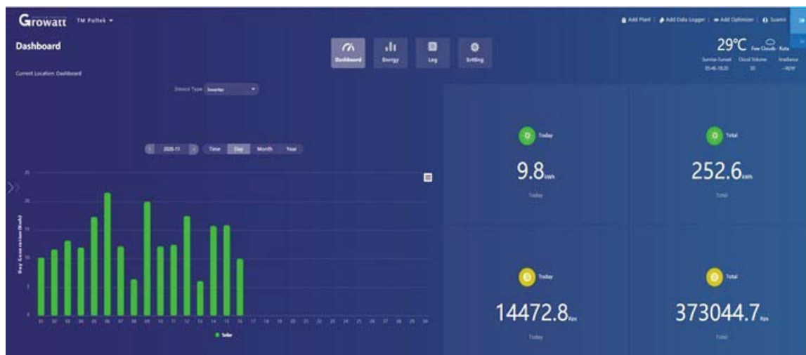
Gambar 1.3 Sistem monitoring untuk produksi energi sistem PLTS melalui komputer dengan jaringan internet
