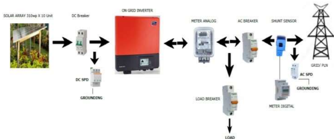
Gambar 1.1 Konsep suplai daya listrik tenaga surya yang dikembangkan melalui penelitian ini
