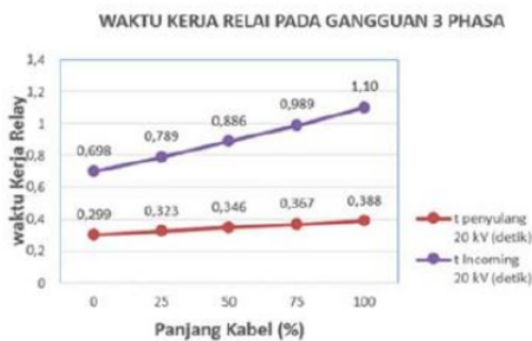
Gambar 9. Kurva Pemeriksaan Waktu kerja Relay untuk Gangguan 3 Fasa
