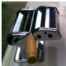
Gambar 1. Penggiling dan Pemotong Kripik Laderang
