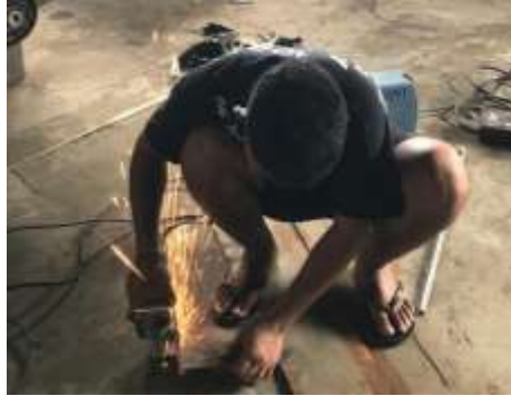
Gambar 4.8 Proses pemotongan plat
