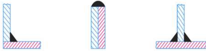
Gambar 2. 8 Tipe lain atau Sambungan las Sumber: Nur dan Suyuti, 2017
