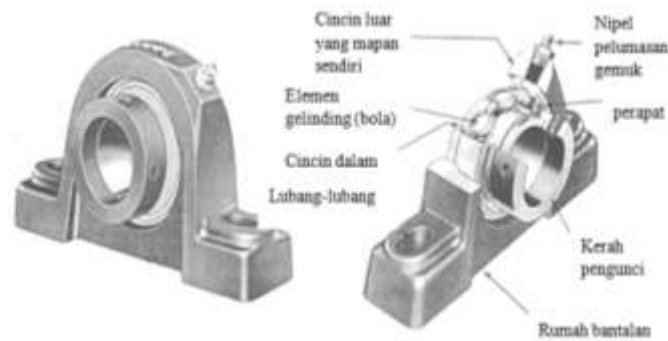
Gambar 2. 10 bagian-bagian dari bantalan Sumber: Mott, (2009)
