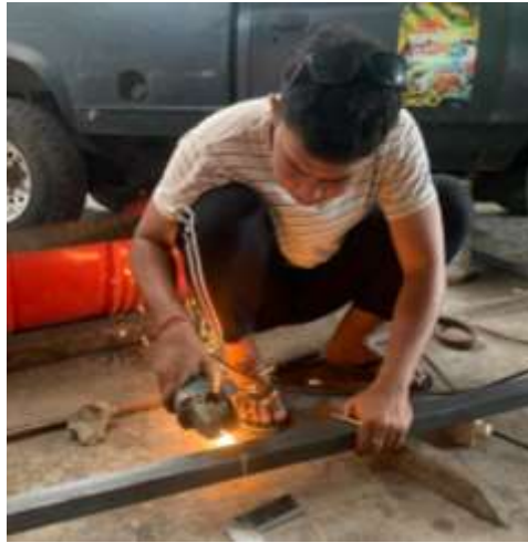
Gambar 4.2 Proses pemtongan rangka penggulingan
