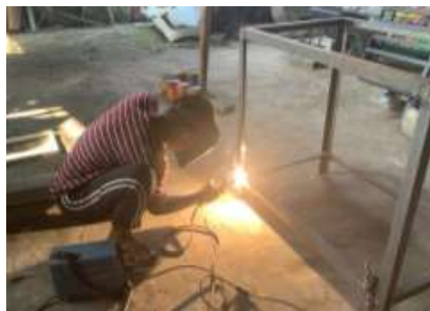
Gambar 4.3 Proses pengelasan rangka penggulingan
