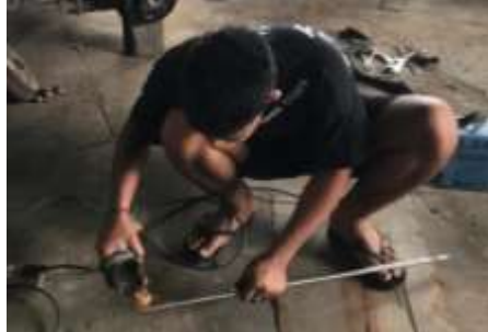
Gambar 4.4 Proses pemotongan poros
