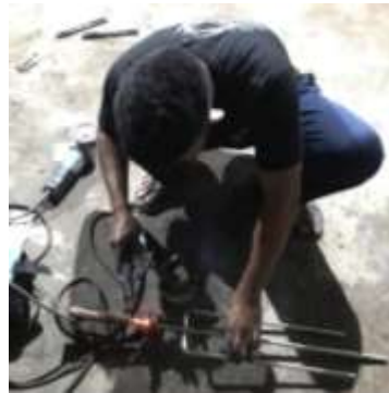
Gambar 4.7 Proses pengelasan poros dan gear
