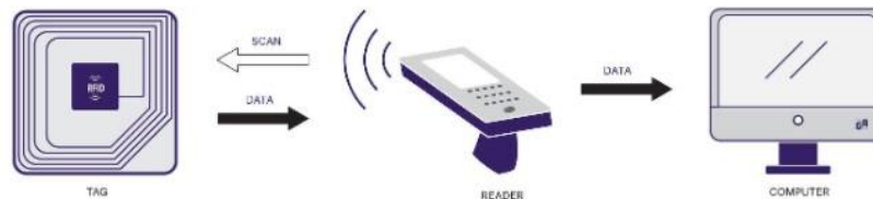
Gambar 2. 1 Sketsa cara kerja teknologi RFID secara sederhana
