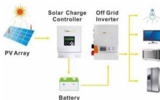
Gambar 2.5 Skema proses pemanfaatan energi surya Sumber : Surya (2016)
