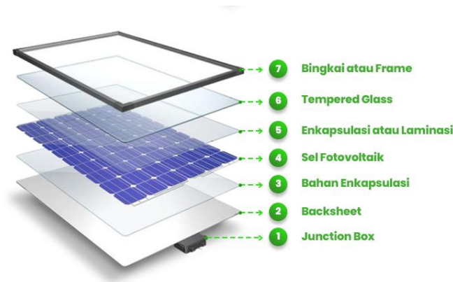
Gambar 2.5 Struktur Solar Cell [13]
