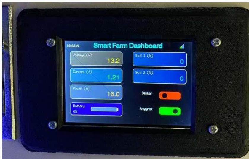
*Gambar 4. 12 Tampilan di LCD TFT*
