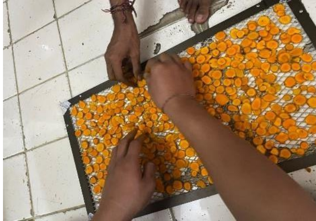
Lampiran 3: Proses penaruhan kunyit di rak mesin pengering
