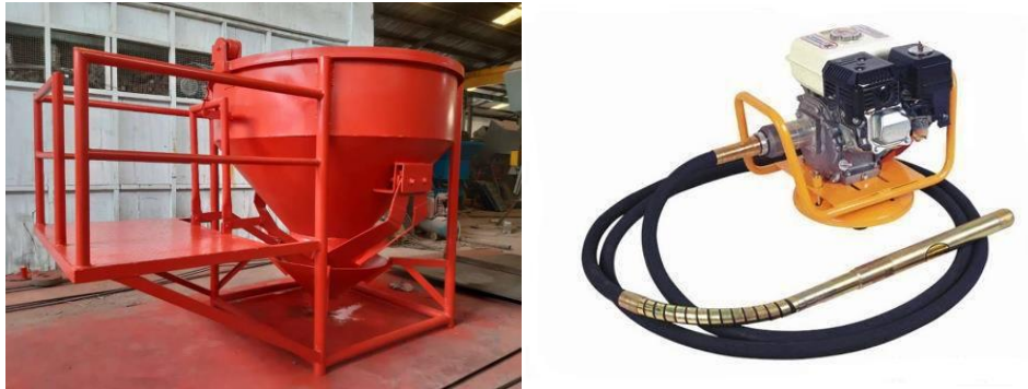
Gambar 2.5 Bucket cor dan Vibrator
