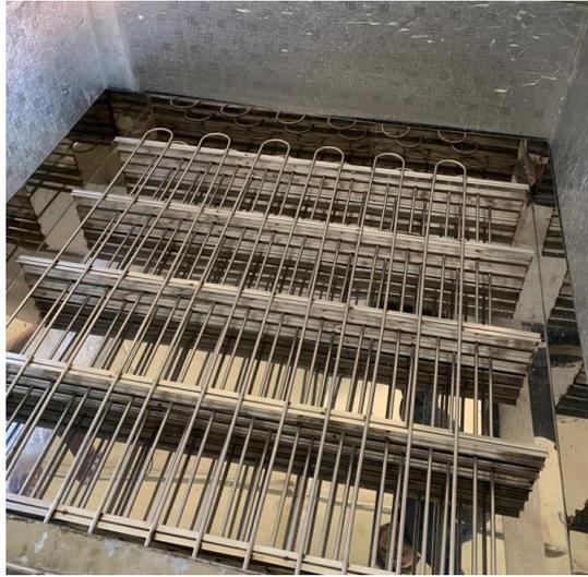
**Gambar 2.** Evaporator dengan wadah yang akan terendam PCM
