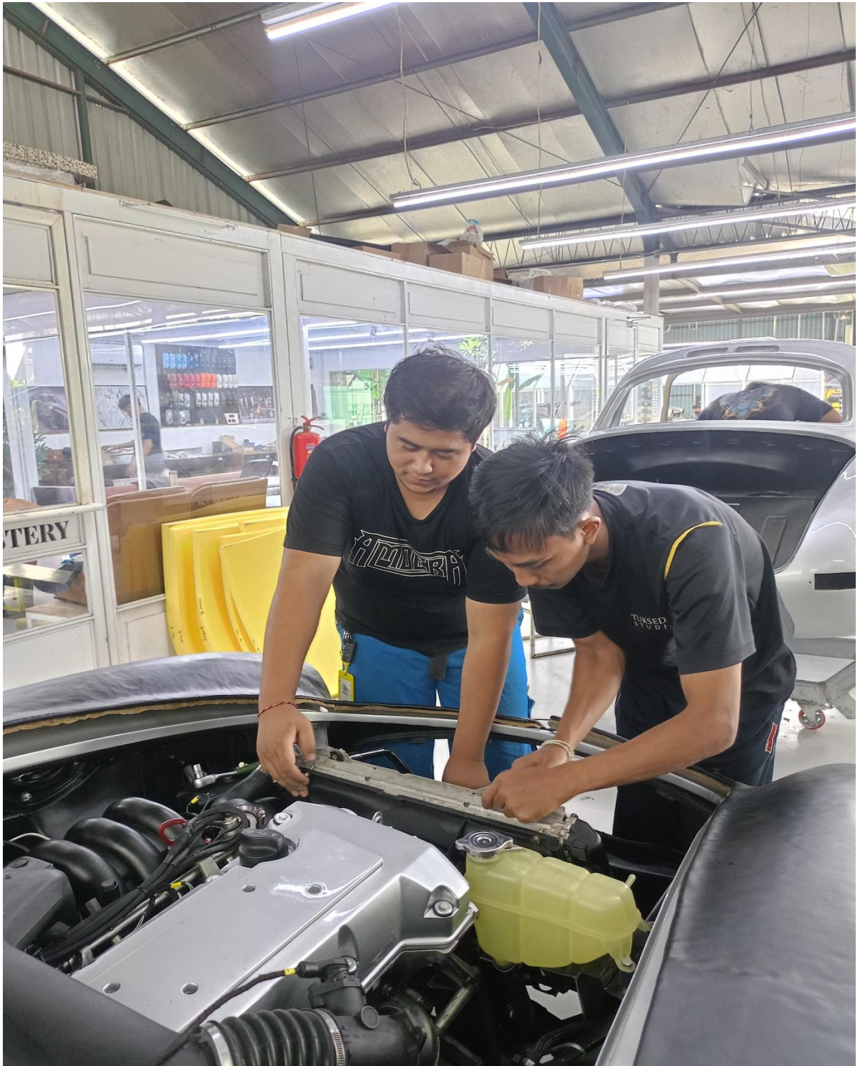
Lampiran 1 Proses pemasangan radiator
