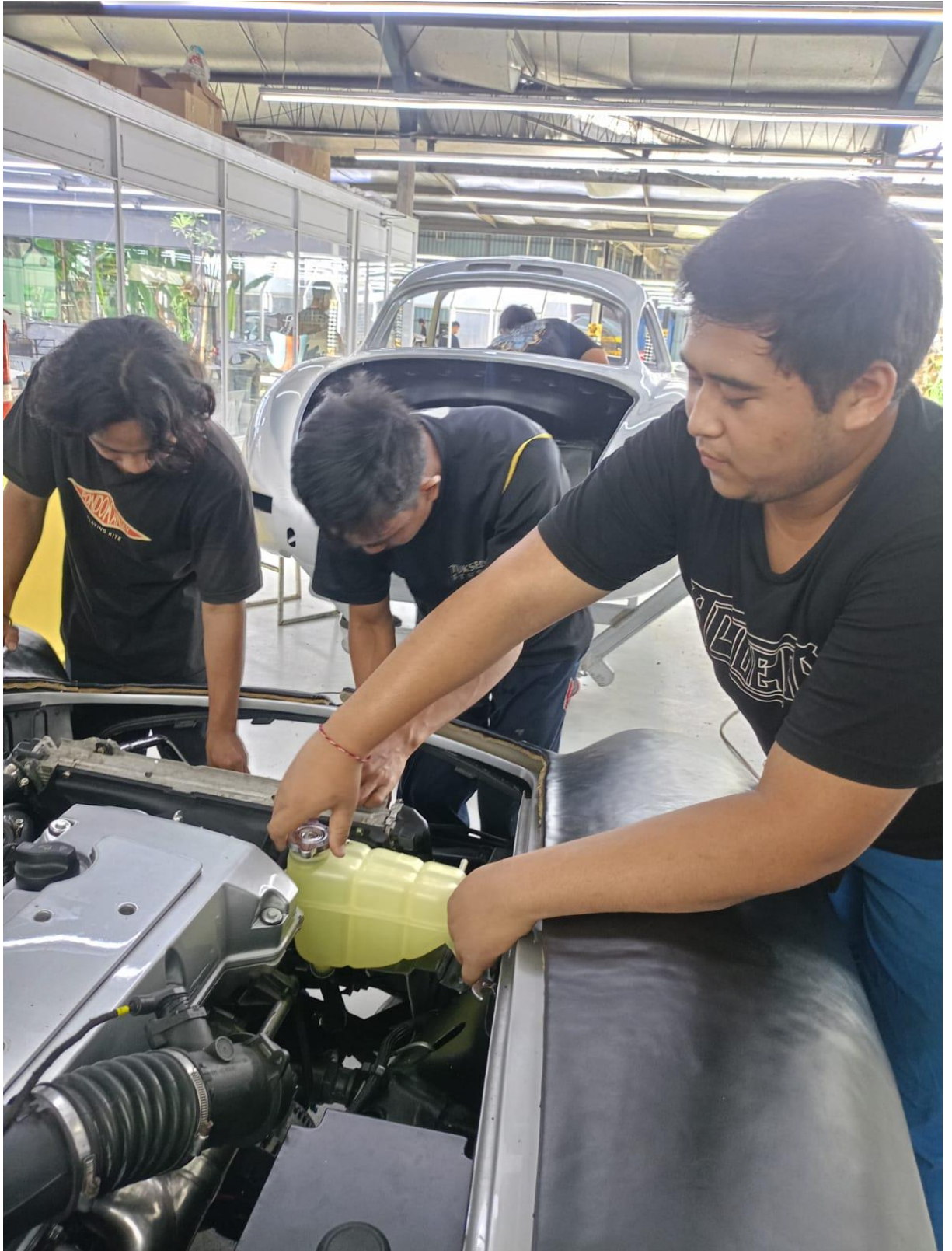
Lampiran 5 Pemasangan reservoir tank dan tutup radiator
