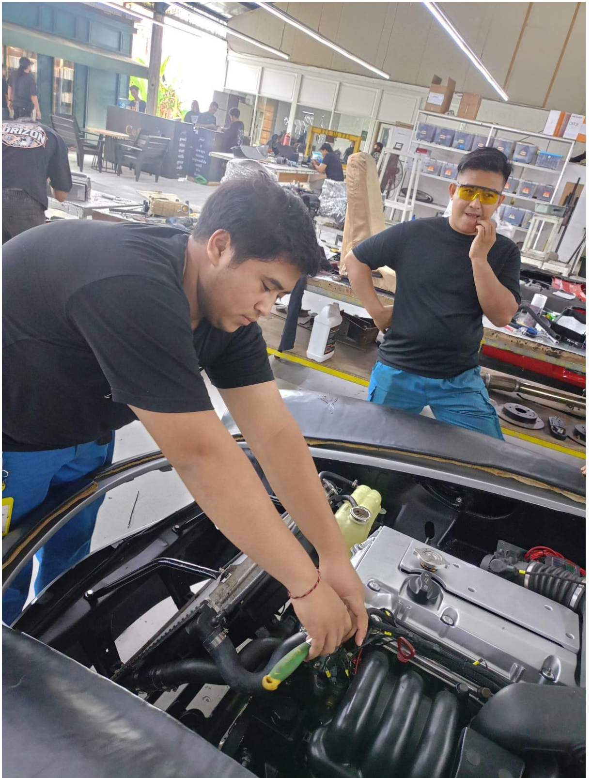
Lampiran 4 Pengencangan baut bleeding
