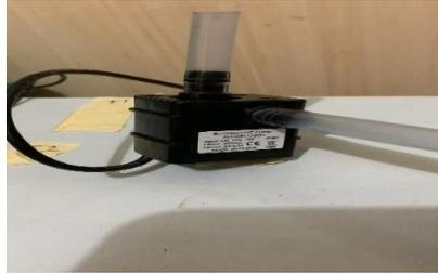
Gambar 17 Pemasangan pompa 12v
