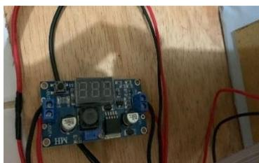
**Gambar 16** Pemasangan *step down*
