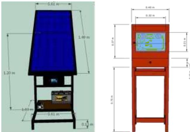
**Gambar 8** Rancangan alat pengering bawang merah hybrid ERk dengan panel surya sebagai sumber energi alternatif
