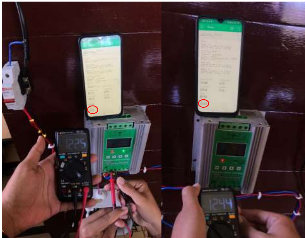
Lampiran 4 Pengujian Sensor Tegangan DC pembacaan tegangan aki
