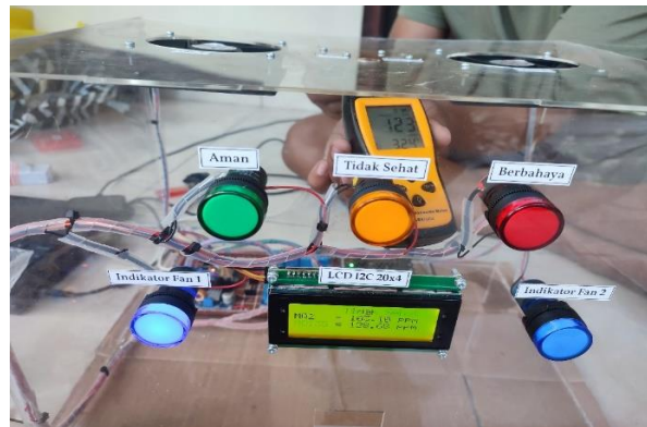
Gambar 3. Proses Pengukuran Kadar Asap dengan Alat Ukur (ppm)
