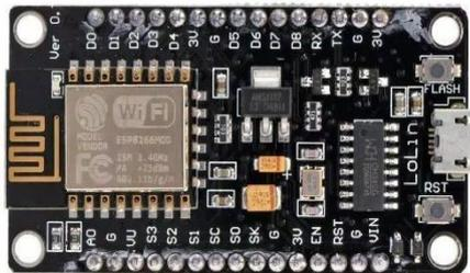
Gambar 2. 1 NodeMCU ESP8266
