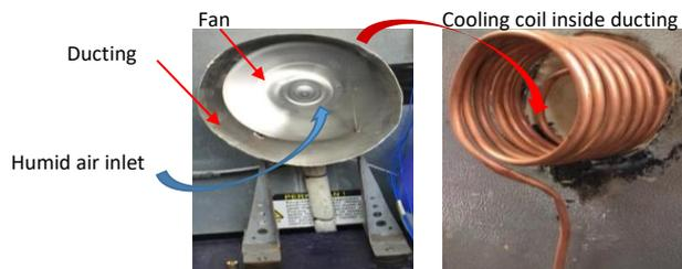
Fig. 6. Natural humidifier test rig
