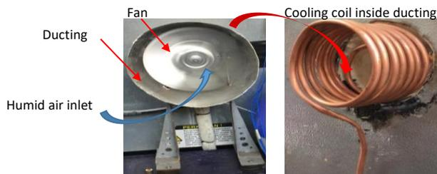
Fig. 6. Natural humidifier test rig
