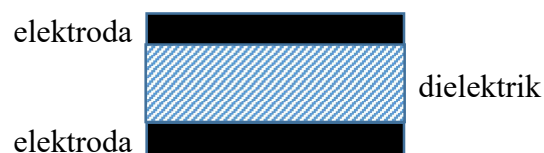
Gambar 5 Prinsip dasar kapasitor
