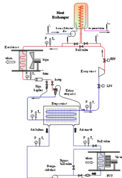
Gambar 1. Diagram Skematik Perangkat Pengujian AC Jenis Water Chiller.
