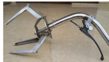
Gambar 2. Hasil Alat Bantu Pemetik Buah salak
